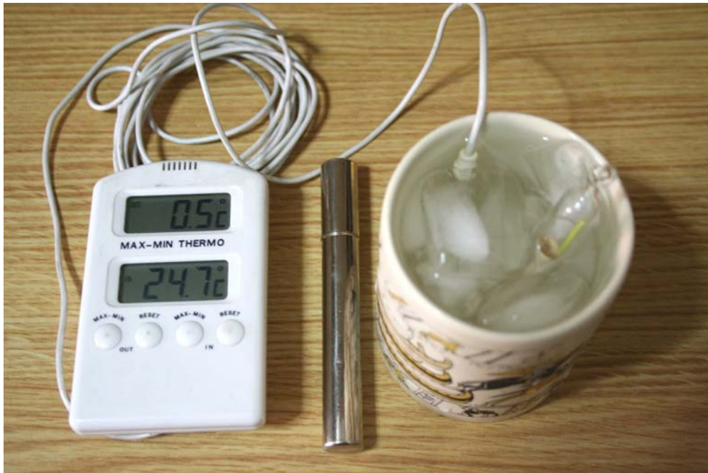
Foto 16.- Calibración del cero.
