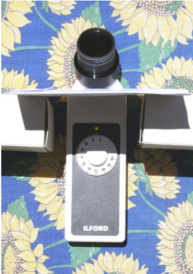
Foto 18.- Prueba con polaroides cruzados.
