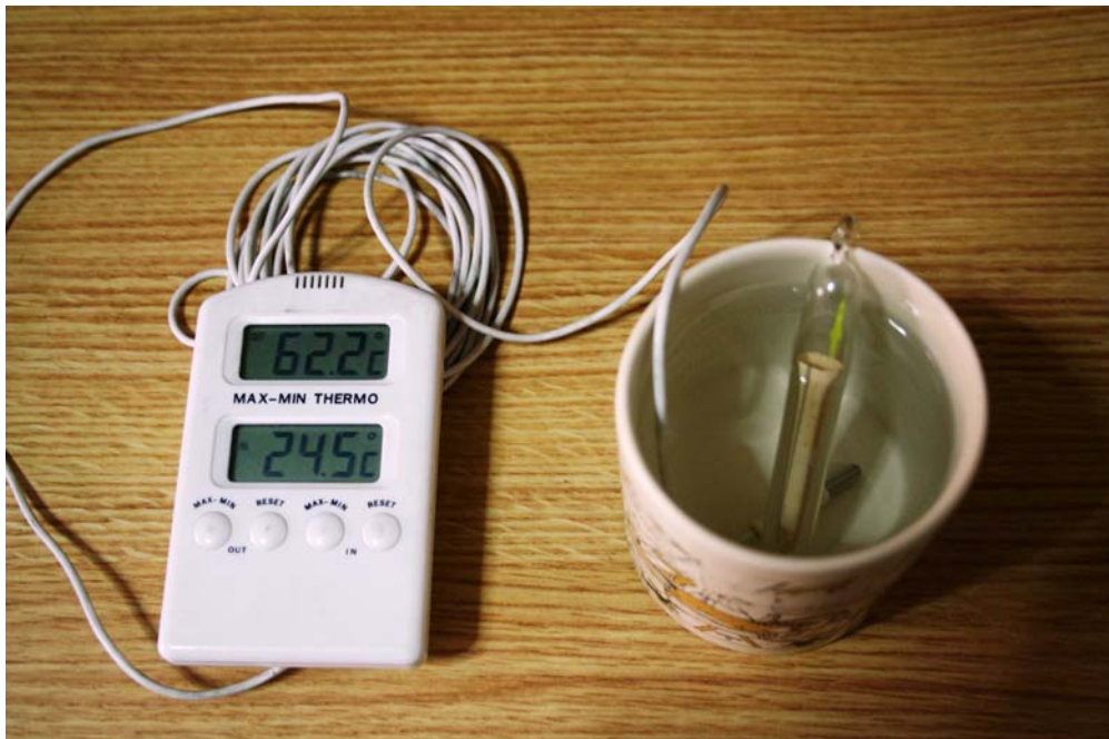
Foto 17.- Calibración del extremo de temperaturas elevadas (60°).
